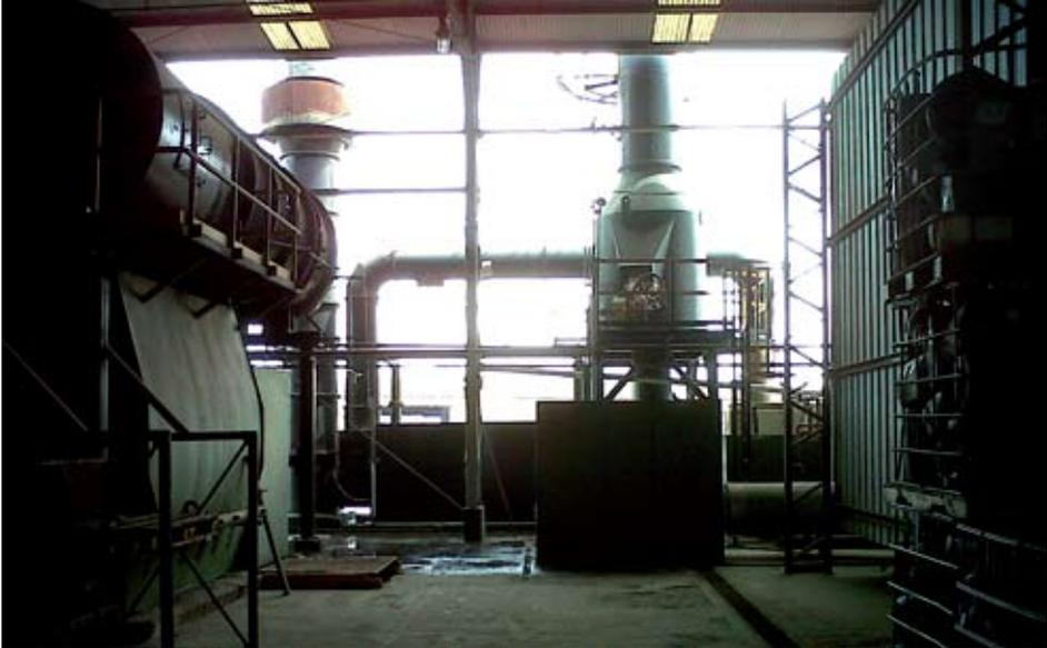
*Instalación de manejo de residuos peligrosos (sistema de horno de incineración pirólítico). Operación de Eliminación Sección A D10 "Incineración en la Tierra" Anexo III Convenio de Basilea*
